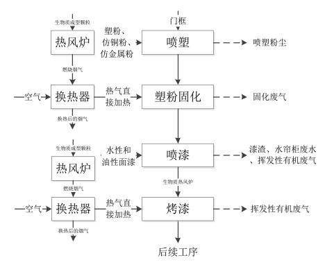
图 3-8 喷塑喷漆工艺流程及产污节点图
