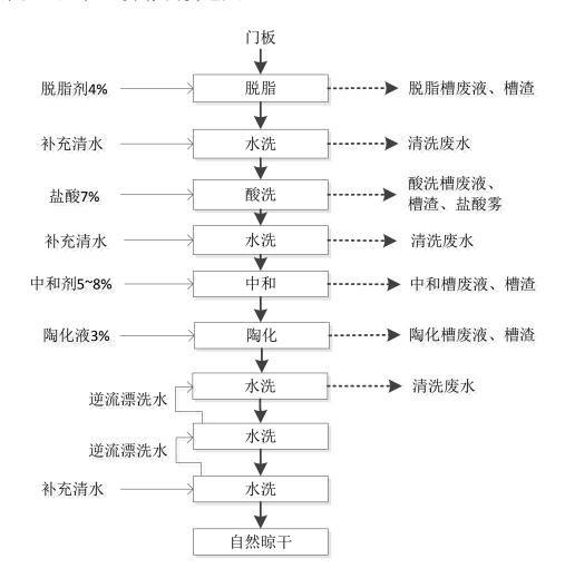
图 3-6 酸洗陶化工艺流程及产污节点图
