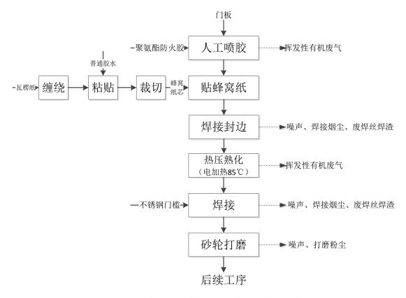
图 3-7 热压胶合和焊边抛磨工艺流程及产污节点图
