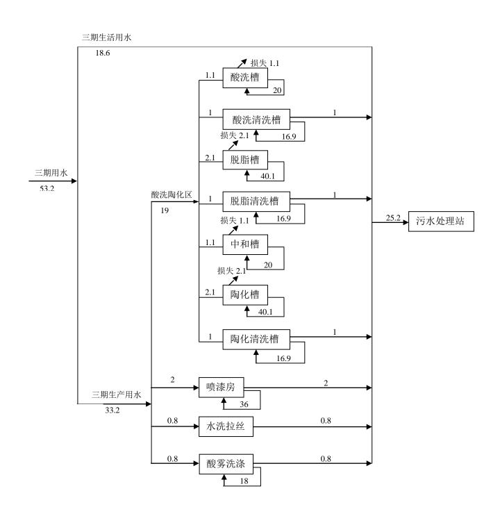
图 3-1 项目总用水量平衡图 m³/d
