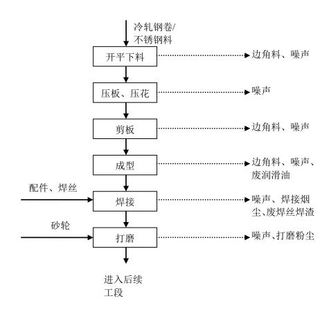
图 3-5 机加工工艺流程及产污节点图
